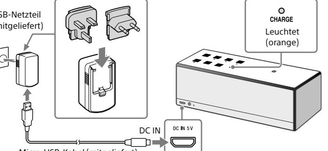
Der Ladevorgang beginnt, wenn das Gerät über das USB-Netzteil an eine Netzsteckdose angeschlossen wird, und die Anzeige CHARGE leuchtet orange. Das Laden des Akkus dauert ungefähr fünf Stunden und danach erlischt die Anzeige.
