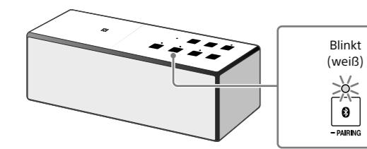
Wenn Sie die BLUETOOTH-Funktion zum ersten Mal verwenden und nur die Taste 0 (BLUETOOTH) – PAIRING drücken, beginnt die Anzeige 0 (BLUETOOTH) schnell weiß zu blinken und das Gerät wechselt automatisch in den Pairing-Modus.
